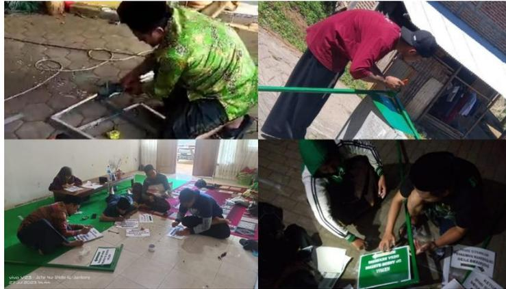
Gambar 3. Pengelasan dan pengecatan tiang dan papan plang.
